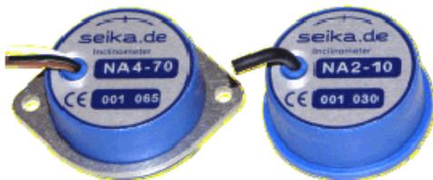
Miniatur-Neigungssensoren mit integriertem 0 bis 5 Volt Spannungsnormierverstärker zur Neigungsmessung in den Messbereichen  $\pm 5$ ,  $\pm 10$ ,  $\pm 30$ ,  $\pm 45$ ,  $\pm 70$  Grad und optionale Messbereiche
